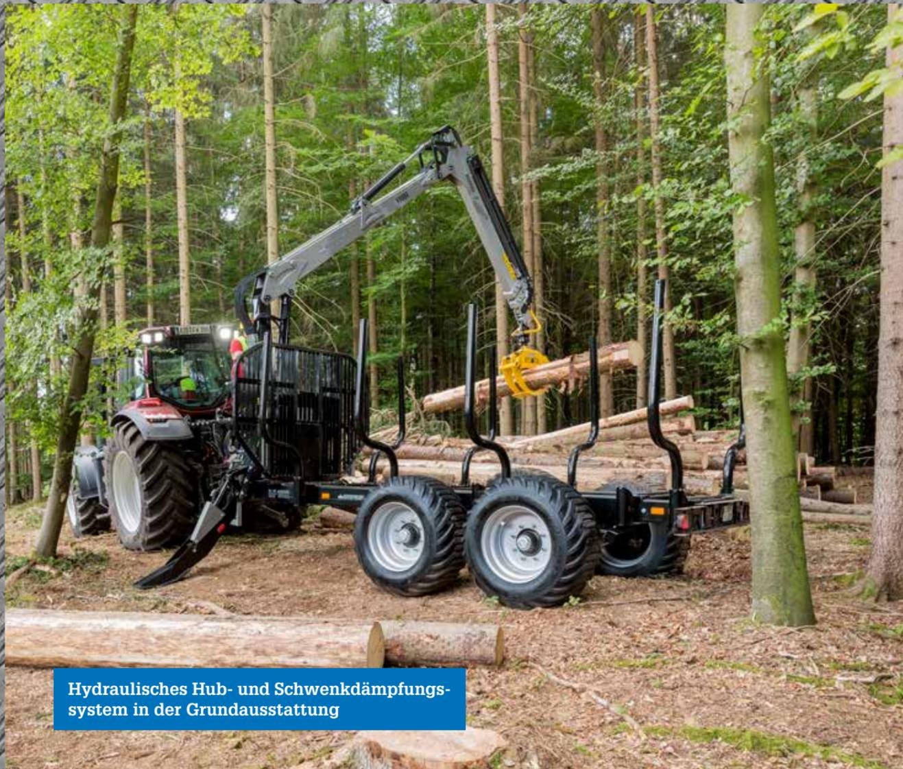
Hydraulisches Hub- und Schwenkdämpfungssystem in der Grundausstattung
