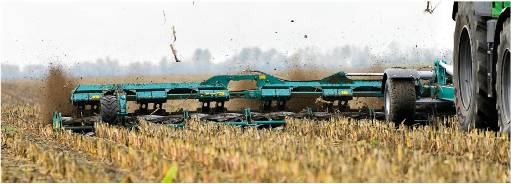
Durch den Klapp-Schwenk-Mechanismus erreicht das größte Modell der **INNO MADE** Messerwalzen eine **Transportbreite von 2,65 m bei einer Gesamtlänge von 7,55 m**.
