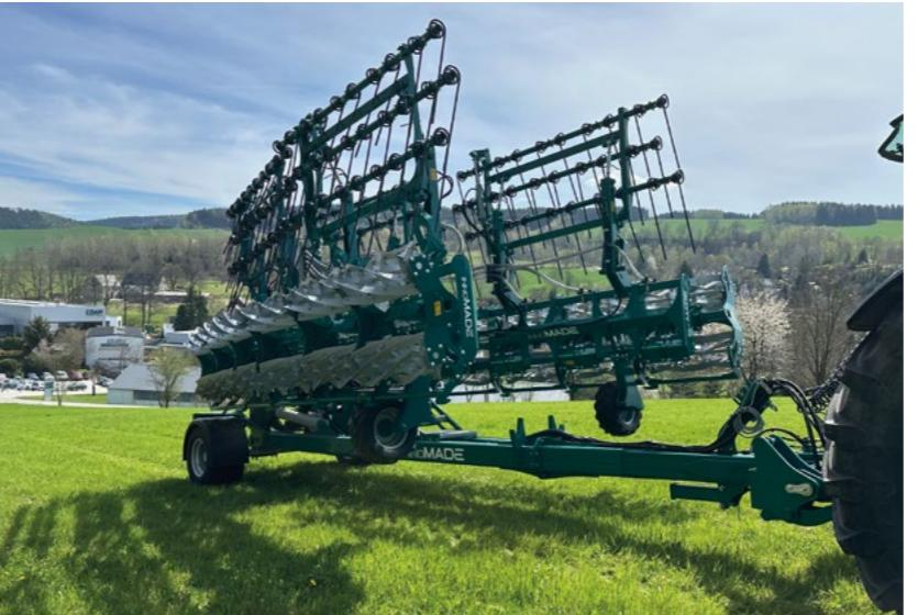
Die MW1250 überzeugt serienmäßig mit einer Unterlenkeranhängung inklusive hydraulischer Verriegelung. Diese sorgt für eine sichere **Stabilisierung der Messerwalze beim Ein- und Ausklappen** – besonders **bei negativer Stützlast**.
