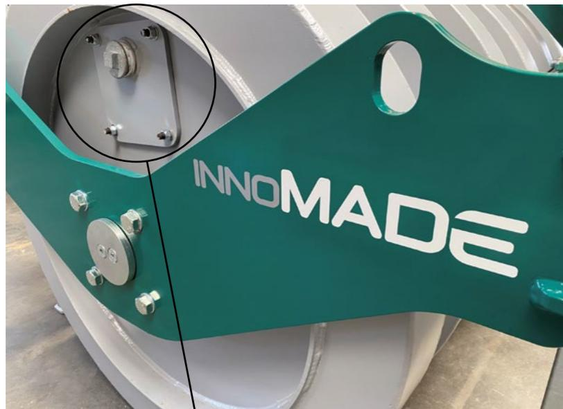
Die **INNO MADE** Silagewalze lässt sich über Seitenöffnungen wahlweise mit Wasser oder Sand befüllen. Mit Sand befüllt, erreicht die SW300 ein maximales Gesamtgewicht von 5.170 kg.
