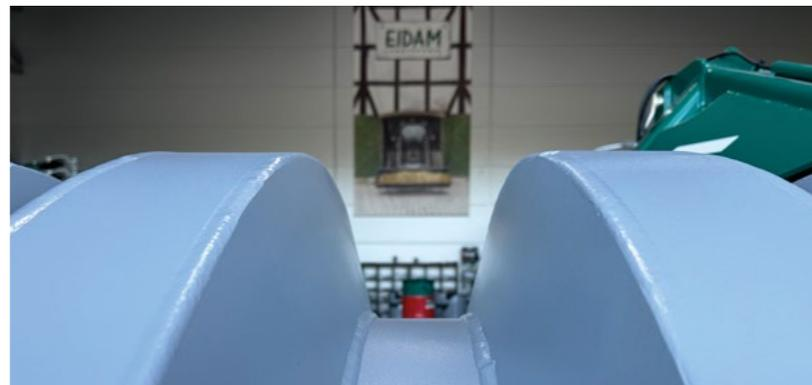
Der große Außendurchmesser von 1.200 mm fördert auch bei ungleichmäßig verteilter Silage ein ruhiges und gleichmäßiges Abrollen. Dank ihres hohen Eigengewichts und des patentierten Walzendesigns wird das Siliergut bereits nach wenigen Überfahrten intensiv verdichtet. Das reduziert Arbeitszeit und Betriebskosten.
